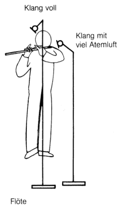
Abb. 19 Mikrofonaufstellung bei Holzblasinstrumenten (hier: Flöte) 61
